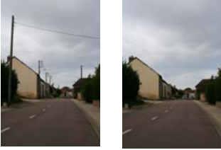
Exemple de mesure compensatoire : Enfouissement de câbles électriques à Magnant (Aube) pour compenser l'effet visuel du parc éolien.
